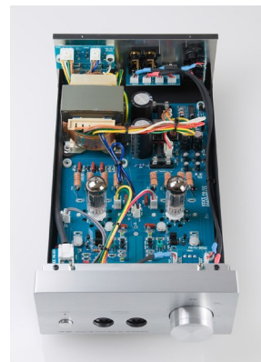
La circuitazione è semplice e il telaio è più rigido. Gli effetti negativi dati dal rumore e vibrazioni sono ridotti.
